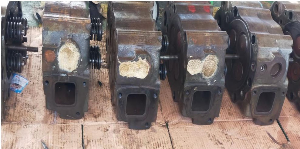
Lampiran 7 Perawatan Kebocoran pada rumah plug cyl L3-L5 pada komponen Cylinder Head Kiri
