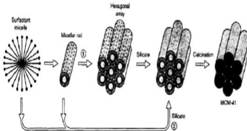
**Gambar 4.** Mekanisme yang terjadi dalam pembentukan MCM-41: (1) Pembentukan fasa kristal cair, (2) Penataan anion silika (Beck dkk., 1992).
