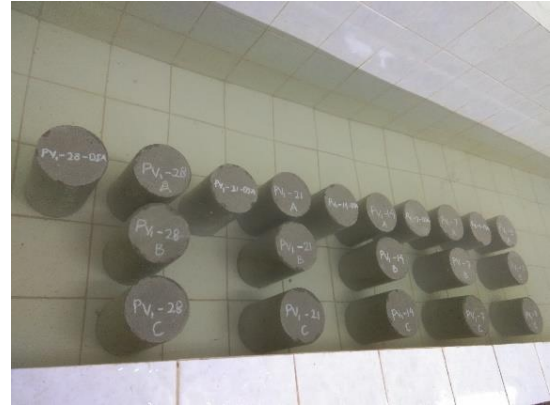
Benda Uji Paving Block PV 1 30% Limbah Gypsum Board Dalam Perawatan Basah ( Wet Curing )
