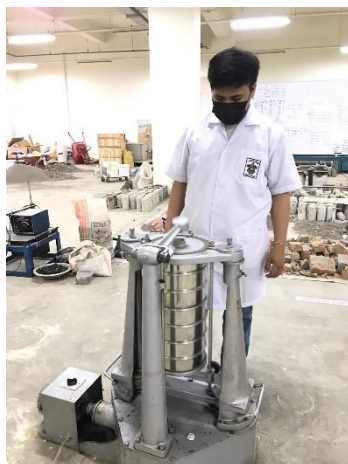
Penyaringan Agregat Halus (Pasir)
