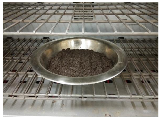
Pengovenan Agregat Halus (Pasir) Untuk Uji Penyerapan Air
