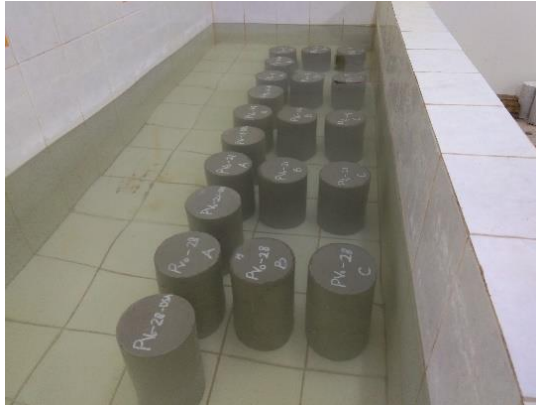
Benda Uji Paving Block Normal PV 0 Dalam Perawatan Basah ( Wet Curing )
