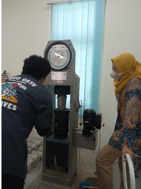
Menguji Kuat Tekan Beton
