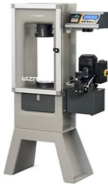
Gambar 2.1. Alat uji tekan beton
