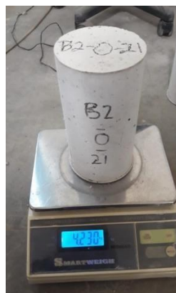
Menimbang berat beton
