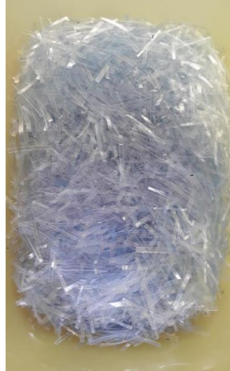
Memotong plastik PET dengan ukuran panjang 2,5cm
