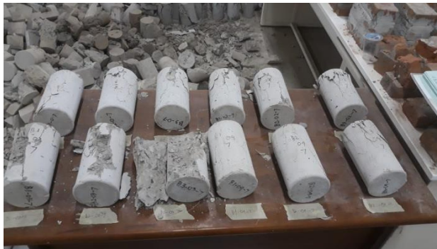
Beton umur 7 hari yang telah melalui tahap pengujian kuat tekan
