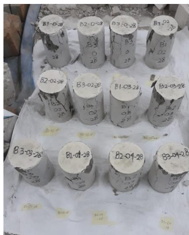
Beton umur 28 hari yang telah melalui tahap pengujian kuat tekan
