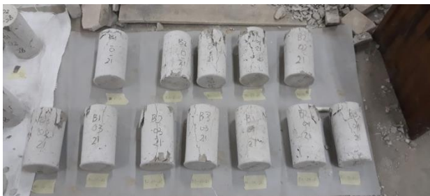
Beton umur 21 hari yang telah melalui tahap pengujian kuat tekan
