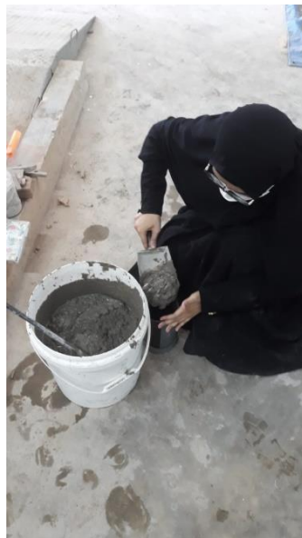
Penuangan beton kedalam cetakan beton berbentuk silinder
