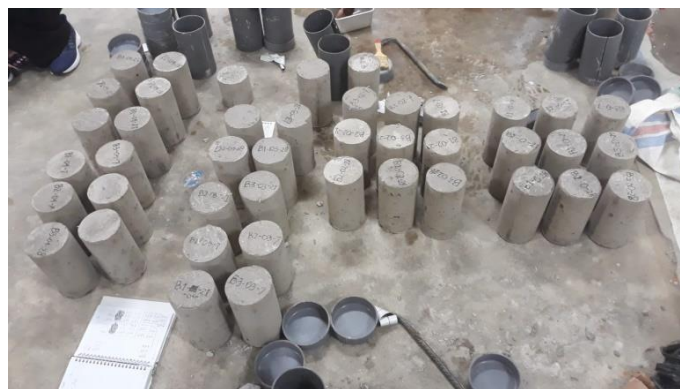
Melepas beton dari bekisting
