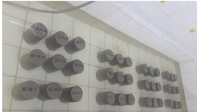
Meletakkan beton pada kolam perendaman
