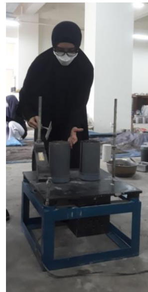
Proses penggetaran beton
