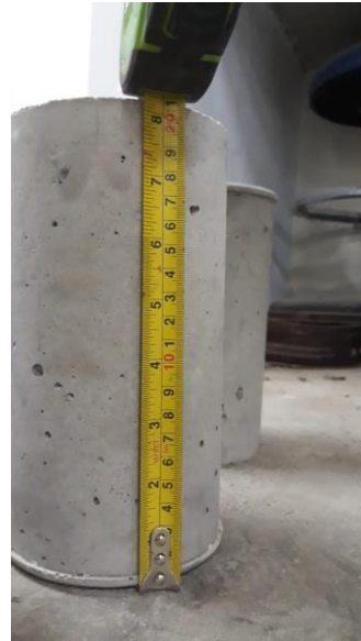
Mengukur tinggi beton
