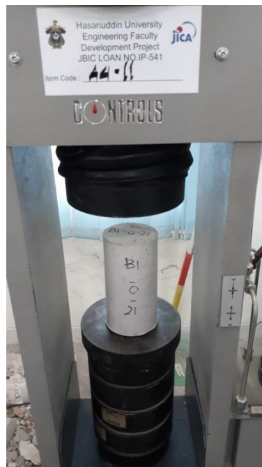
Proses pengujian kuat tekan menggunakan UTM
