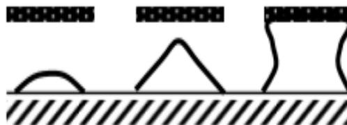
Gambar 2. 2 Pembentukan Tombolo pada pantai yang dipasang Breakwater
