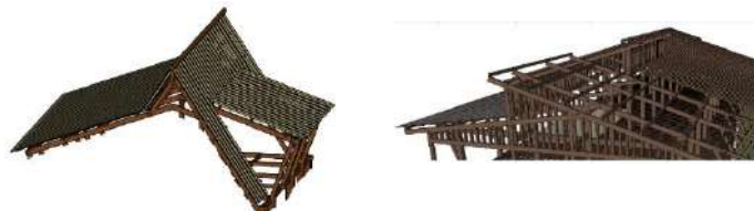
Gambar 12. Struktur Rangka Atap Cottage dan Front Office
