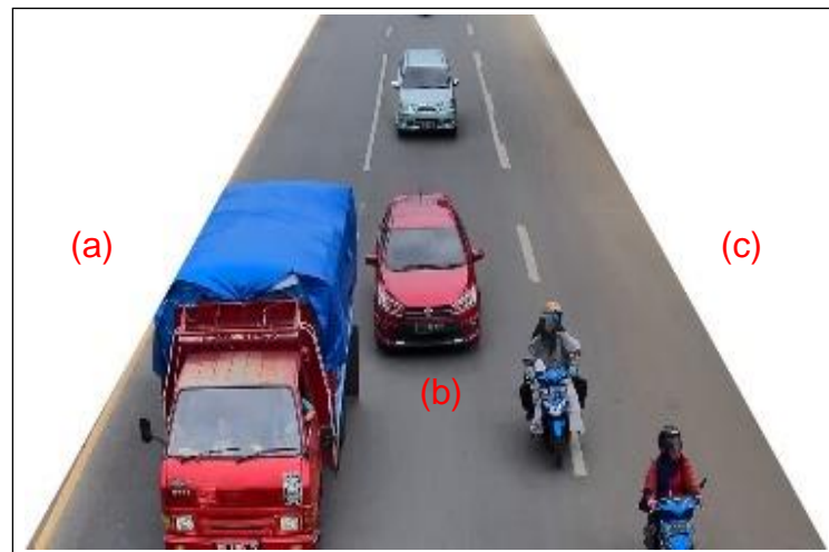
Gambar 4. ROI pada pendeteksian kendaraan, (a) dan (c) ialah area yang tidak ingin diproses/dideteksi, (b) area yang ingin dideteksi/diamati.
