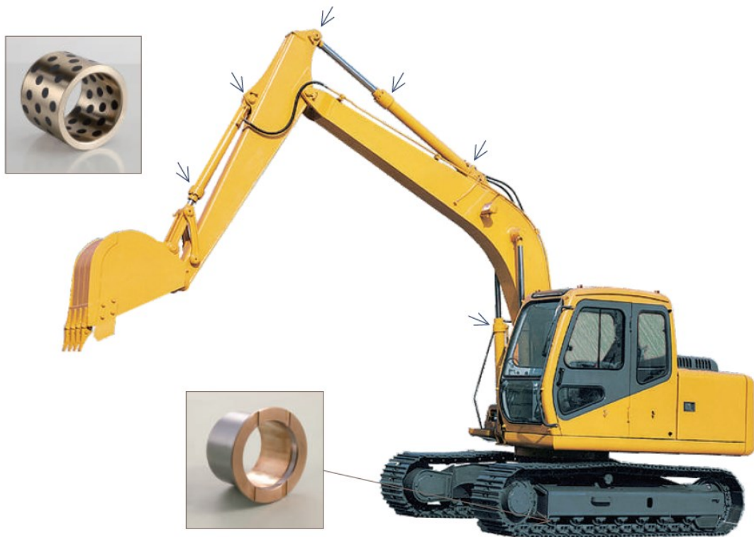
Gambar 2.20 Aplikasi Bimetal Bearing DYB-300 untuk alat berat (Sumber: Jiashan DI Bearing Co. Ltd.)
