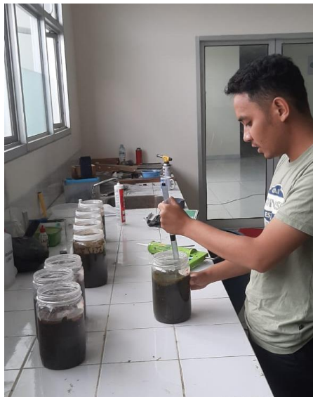
Mengukur kadar pH slurry sebelum dimasukkan ke dalam biodigester
