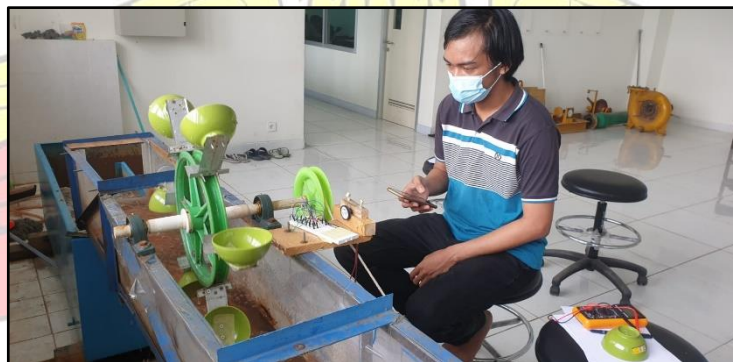
Gambar C2. Dokumentasi Pengambilan Data Turbin Air Material Sudu Melamin
