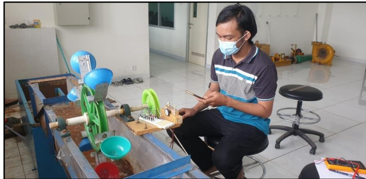
Gambar C1. Dokumentasi Pengambilan Data Turbin Air Material Sudu Plastik
