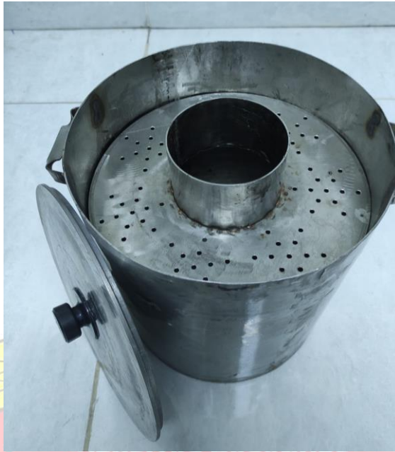
Gambar B1 : Steamer tanpa dudukan TEG
