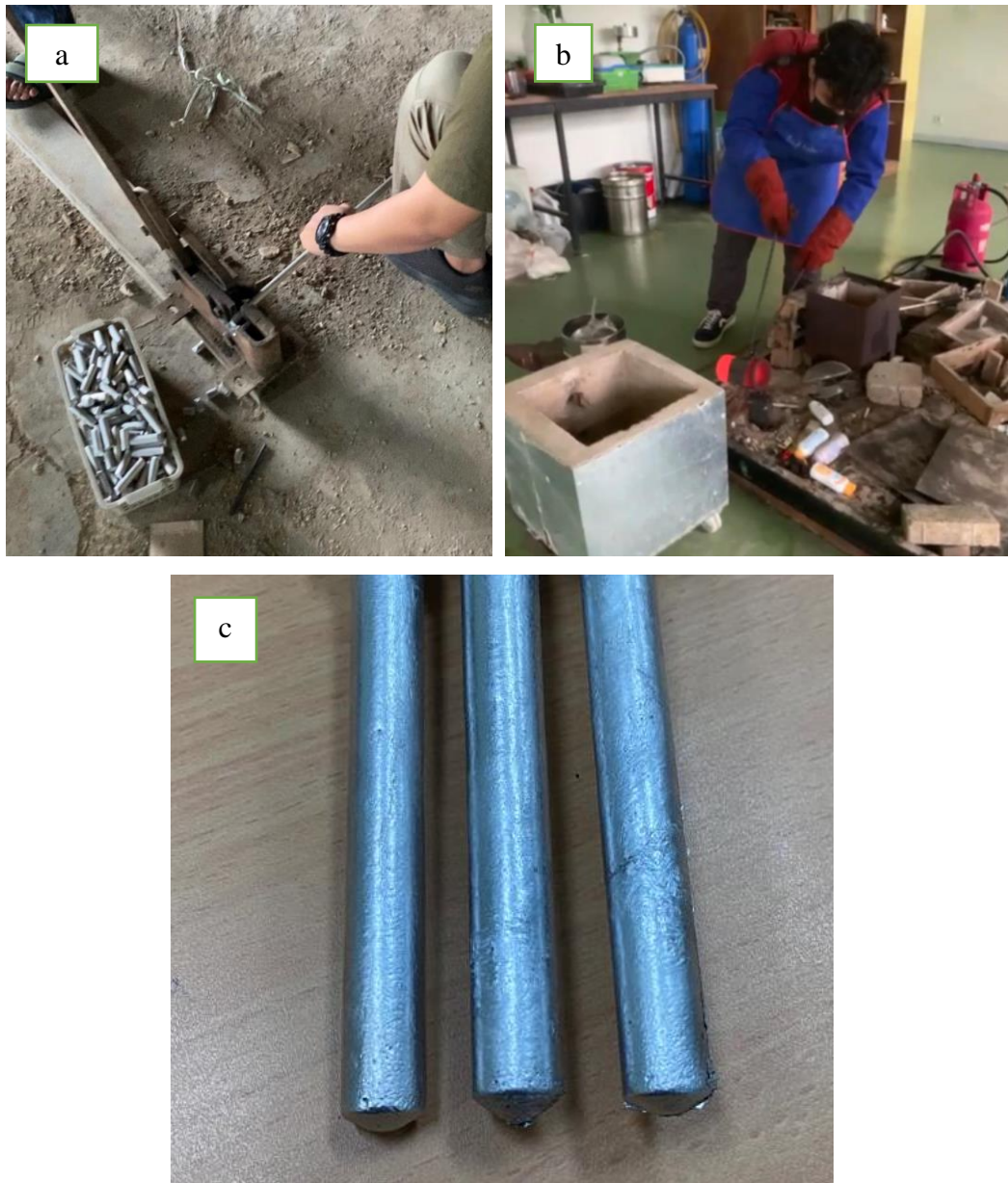
Gambar A.4 Proses pembuatan rod (a) pemotongan batang aluminium 6061 (b) penuangan cairan aluminium 6061+CNT 1,5% (c) spesimen rod
