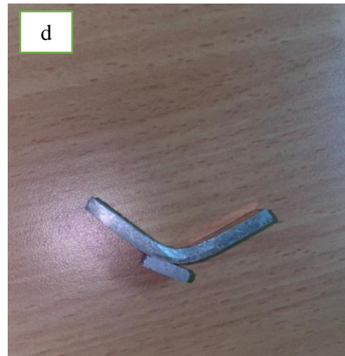
Gambar A.9 Pengujian banding (a) Mesin uji banding Testing (b) computer input data banding (c) pengambilan data uji banding (d) Hasil spesimen setelah uji banding
