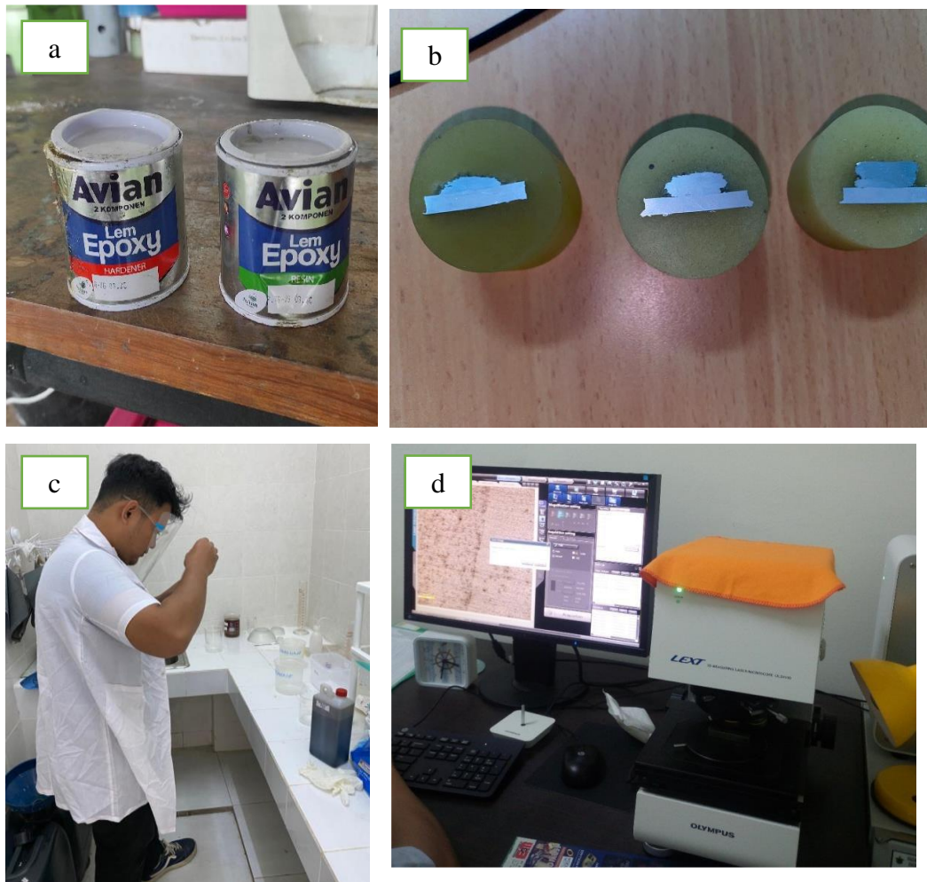
Gambar A.11 Pembuatan spesimen pengujian struktur mikro (a) pembuatan spesimen menggunakan resin avian epoxy (b) Spesimen pengujian struktur mikro (c) melakukan pengesanan spesimen menggunakan etsa Keller Reagent (d) alat pengujian struktur mikro
