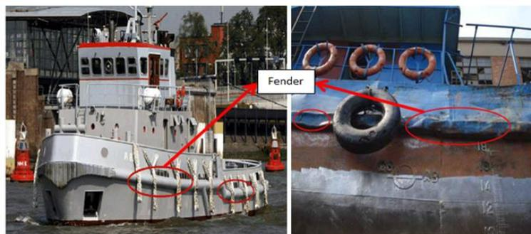
**Gambar 0.1** Struktur fender sebagai komponen keselamatan pada kapal laut (Zhiyu Jiang, 2009).
