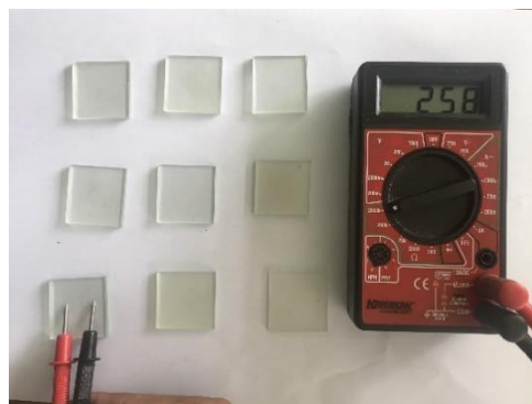
L.6. Pengukuran resistansi pada kaca konduktif setelah melalui proses penyemprotan larutan \text{SnCl}_2 dan pemanasan 500^{\circ}\text{C} selama 10 menit.
