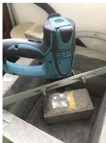
L.9. Proses pemanasan kaca konduktif yang telah di lapisi TiO 2
