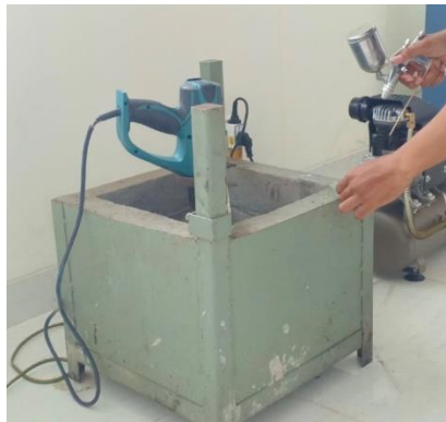
L.5. Proses penyemprotan larutan \text{SnCl}_2 + alkohol pada kaca dengan menggunakan spray gun secara merata.
