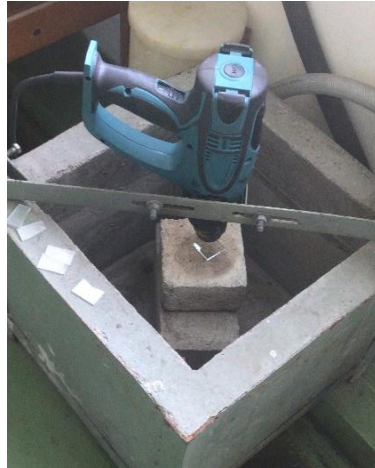
L.4. Proses pemanasan kaca menggunakan heatgun bersuhu 500^{\circ}\text{C} selama 10 menit.
