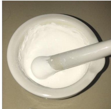
L.7. Proses pembuatan pasta TiO 2 dengan mencampurkan 1 gr HEC + 25 ml etanol dan 6 gr TiO 2 + 9 ml asam asetat.
