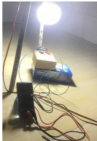
L.17. Pengukuran V_{oc} (Tegangan Open Circuit ) dan I_{sc} (Arus Short Circuit ) pada DSSC yang telah dirakit.
