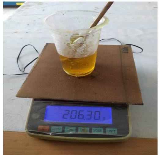
MENIMBANG DAN MENCAMPUR RESIN EPOXY DAN HAREDENER
