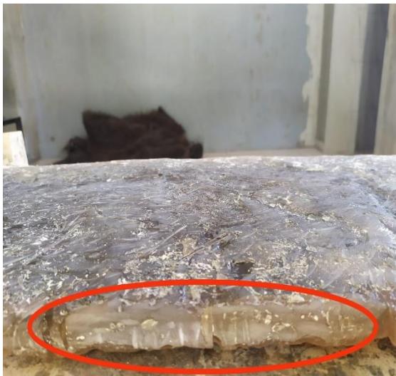
BEBARAPA KEGAGALAN DAN CACAT BENTUK PADA PROSES FABRIKASI BILAH ( WARPING DAN POROSITAS )
