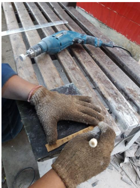
MENGUKUR DIMENSI DAN MEMOTONG SESUAI STANDAR SPESIMEN UJI
