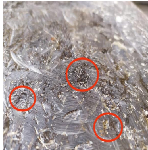
BEBARAPA KEGAGALAN DAN CACAT BENTUK PADA PROSES FABRIKASI BILAH ( WARPING DAN POROSITAS )
