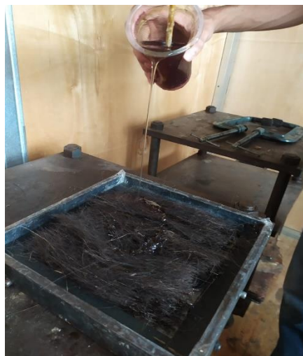
MENUANGKAN & MENGISI CETAKAN DENGAN RESIN DAN SERAT IJUK
