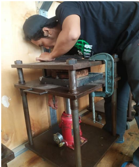
MELAKUKAN PENEKANAN/ PRESS PADA CETAKAN
