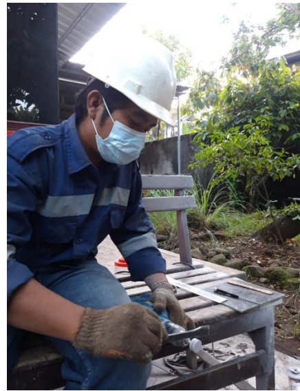
MEMOTONG MATERIAL KOMPOSIT SESUAI STANDAR SPESIMEN UJI
