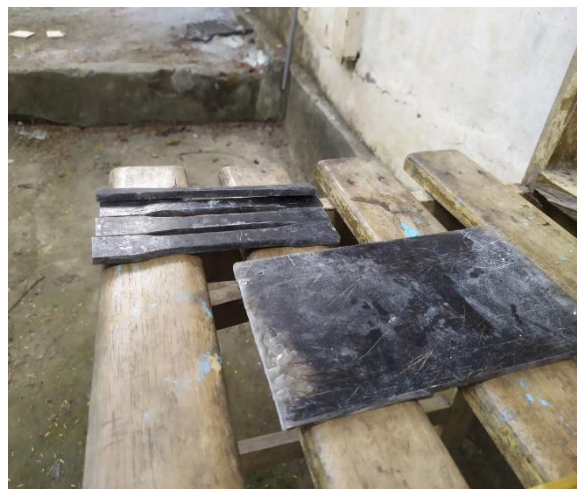
HASIL PEMOTONGAN SPESIMEN UJI TARIK DAN UJI BENDING
