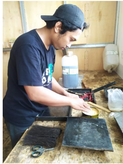
MENYIAPKAN & MENGOLESKAN MIRROR GLAZE PADA CETAKAN
