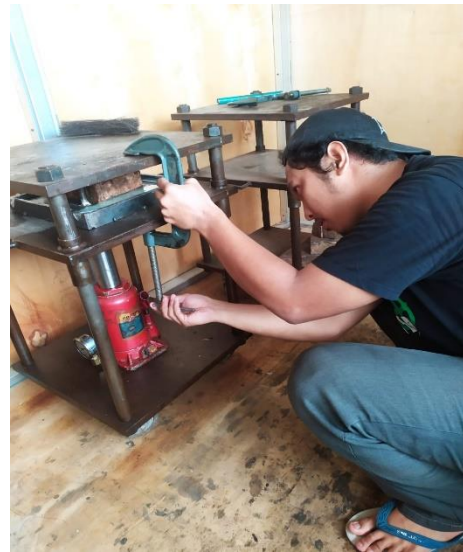
MELAKUKAN PENEKANAN/ PRESS PADA CETAKAN
