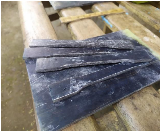
MEMOTONG MATERIAL KOMPOSIT SESUAI STANDAR SPESIMEN UJI
