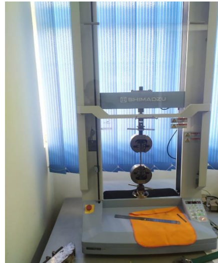
MELAKUKAN PEMANASAN SELAMA 2 JAM DENGAN SUHU 60°C & MELAKUKAN PENGUJIAN PADA SPESIMEN
