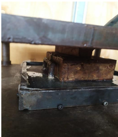
MELAKUKAN PENEKANAN/ PRESS PADA CETAKAN
