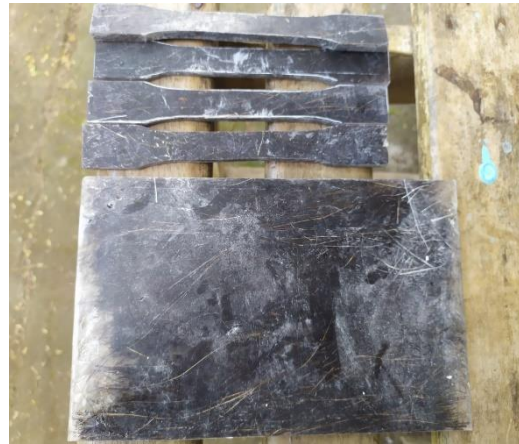
MEMOTONG MATERIAL KOMPOSIT SESUAI STANDAR SPESIMEN UJI
