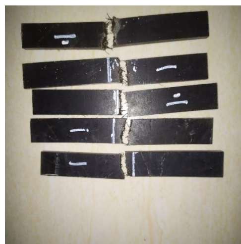
SPESIMEN UJI BENDING SEBELUM DAN SETELAH PENGUJIAN
