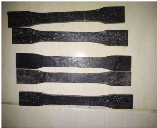
SPESIMEN UJI TARIK SEBELUM DAN SETELAH PENGUJIAN
