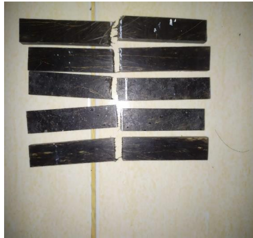
SPESIMEN UJI BENDING SEBELUM DAN SETELAH PENGUJIAN
