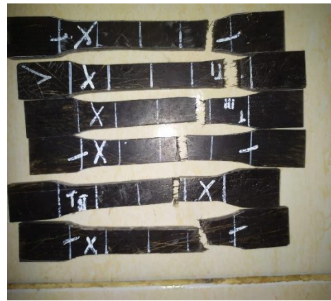
SPESIMEN UJI TARIK SEBELUM DAN SETELAH PENGUJIAN
