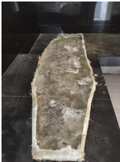
MASTER CETAKAN DAN CETAKAN UNTUK FABRIKASI BILAH
