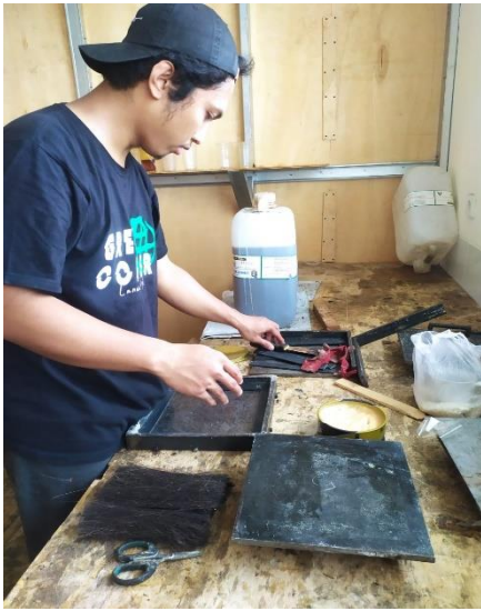
MENYIAPKAN & MENGOLESKAN MIRROR GLAZE PADA CETAKAN
