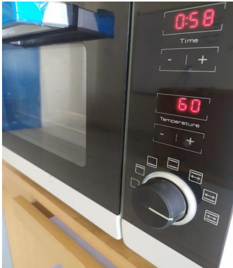
MELAKUKAN PEMANASAN SELAMA 2 JAM DENGAN SUHU 60°C & MELAKUKAN PENGUJIAN PADA SPESIMEN
