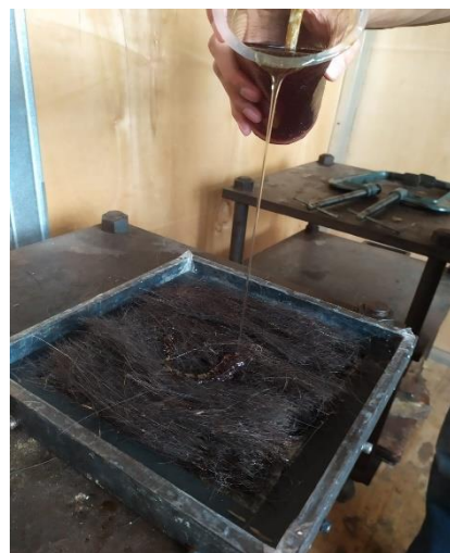
MENUANGKAN & MENGISI CETAKAN DENGAN RESIN DAN SERAT IJUK
