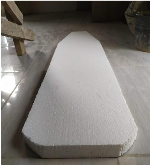
SPESIMEN UJI BENDING SEBELUM DAN SETELAH PENGUJIAN
