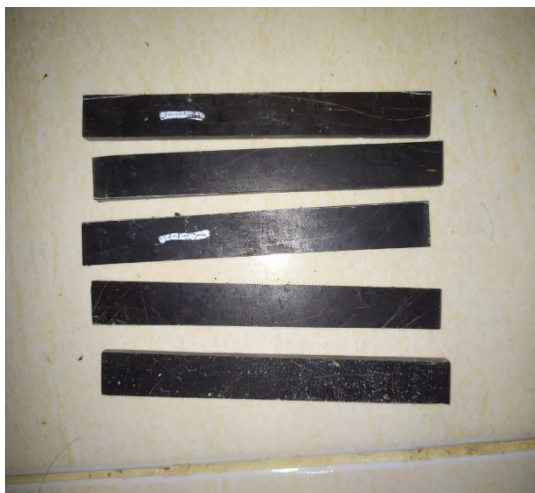
SPESIMEN UJI BENDING SEBELUM DAN SETELAH PENGUJIAN
