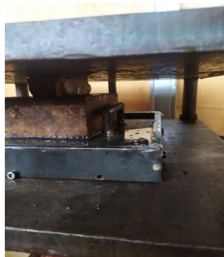
MELAKUKAN PENEKANAN/ PRESS PADA CETAKAN
