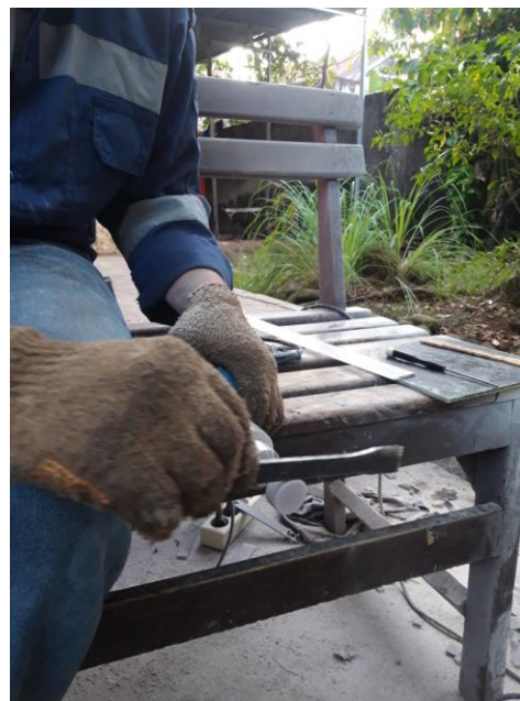
MENGUKUR DIMENSI DAN MEMOTONG SESUAI STANDAR SPESIMEN UJI
