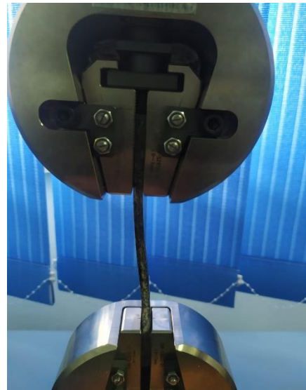
MELAKUKAN PEMANASAN SELAMA 2 JAM DENGAN SUHU 60°C & MELAKUKAN PENGUJIAN PADA SPESIMEN
