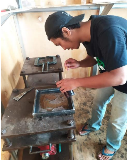
MENYIAPKAN & MENGOLESKAN MIRROR GLAZE PADA CETAKAN
