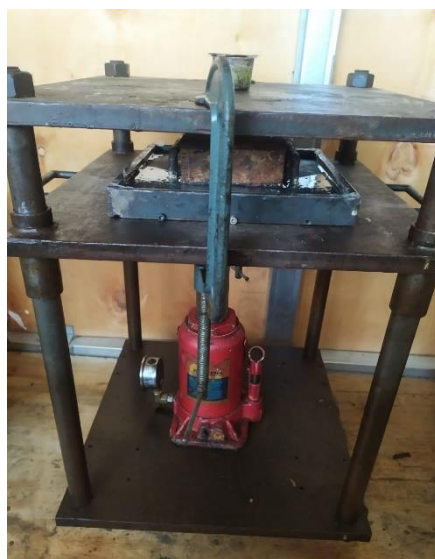
MENGGUNAKAN KLEM PADA ALAT PRESS UNTUK MENEKAN CETAKAN
