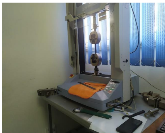
MELAKUKAN PENGUJIAN TARI DAN BENDING PADA UNIVERSAL TESTING MACHINE
