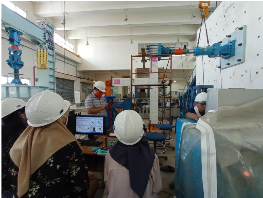
Pengujian Balok – Kolom dengan Sambungan 2 Pasak (BG1)
