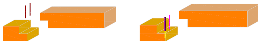
Gambar 7. Gambar sambungan pasak
