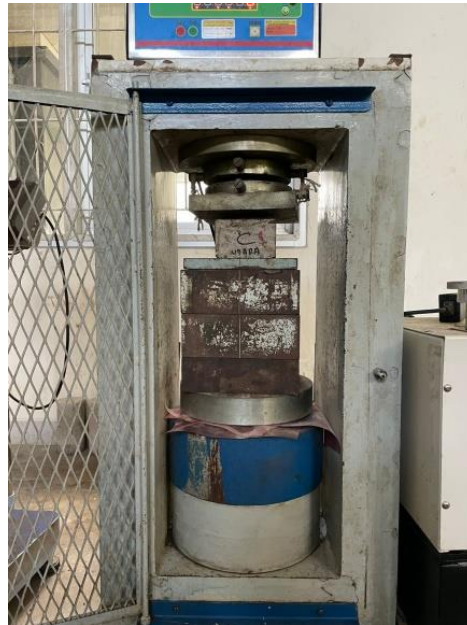
Gambar. 3 Pengujian Kuat Tekan Paving block
