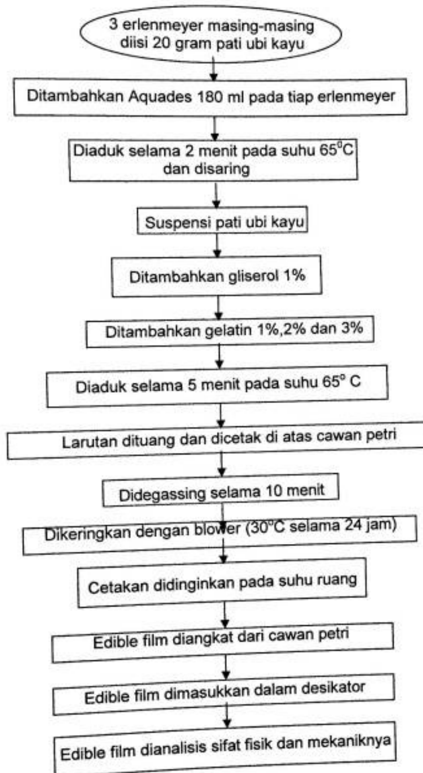
Gambar 1. Diagram alir penentuan konsentrasi gelatin yang terbaik pada edible film pati ubi kayu
