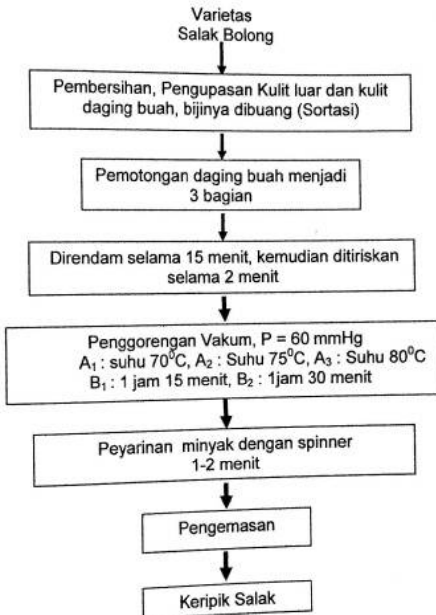
Gambar 2. Diagram Alir Pembuatan Keripik Salak
