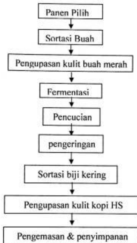
Gambar 3. Alur proses pengolahan kopi dengan cara basah (fully washed)
