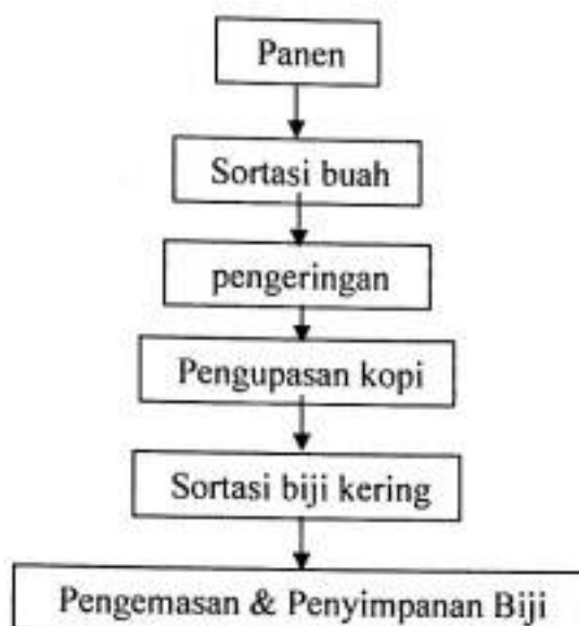
Gambar 1. Diagram alir pengolahan kopi dengan cara kering
