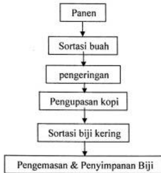
Gambar 1. Diagram alir pengolahan kopi dengan cara kering
