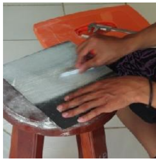
Pembuatan Spesimen Uji Impak
