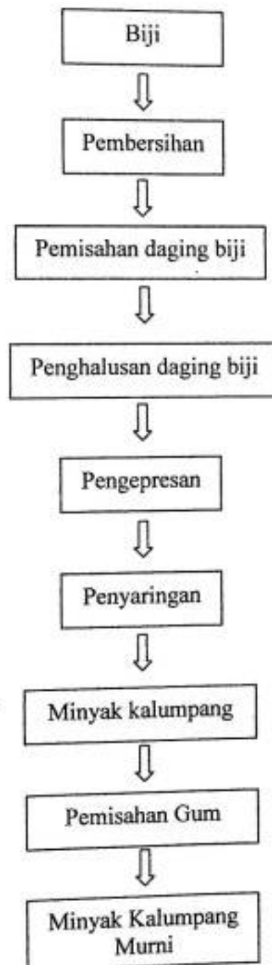
Gambar 2. Bagan Alir Proses Pembuatan Minyak Mentah Biji Kalumpang
