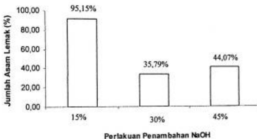
Gambar 5. Jumlah Asam Lemak Sabun dari Minyak Kalumpang dengan berbagai Penambahan Konsentrasi NaOH
