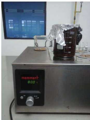
Gambar 8. Ekstraksi dengan Etanol 80%
