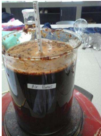
Gambar 10. Ekstraksi dengan Air Panas pada suhu 85°C
