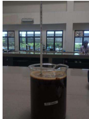
Gambar 11. Ekstraksi dengan Air Dingin pada suhu 25°C
