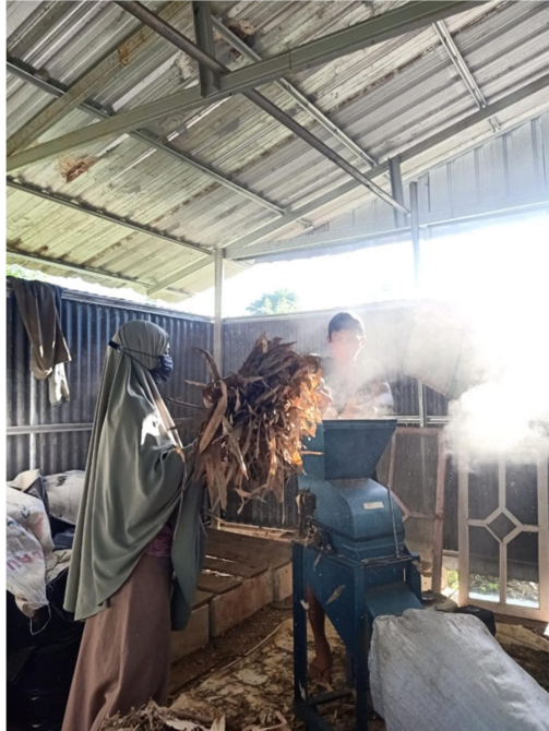
Gambar proses pencacahan serasah daun bambu
