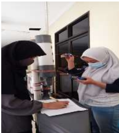
3. Pengukuran suhu pengeringan cengkeh basah
