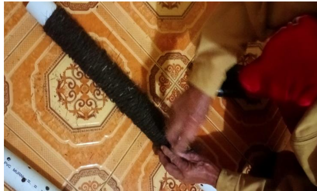
Gambar L-5. Proses pelilitan tali ijuk pada pipa berpori.
