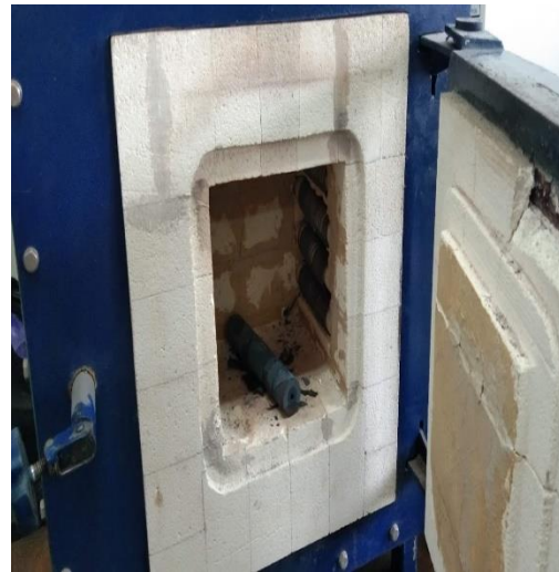
Gambar A.8 : Material setelah annealing
