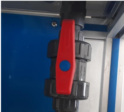
Gambar B1. Pembukaan katup saluran masuk 100% dan 80%
