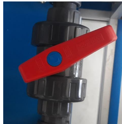
Gambar B2. Pembukaan katup saluran masuk 60% dan 40%
