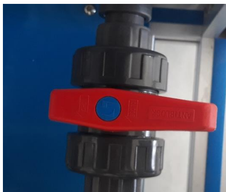
Gambar B3. Pembukaan katup saluran masuk 0%
