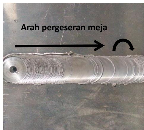
Gambar 2. 7 Hasil pengelasan friction stir welding dengan kecepatan feed rate 18 cm/menit (Lukito Adi Wicaksono,2016).
