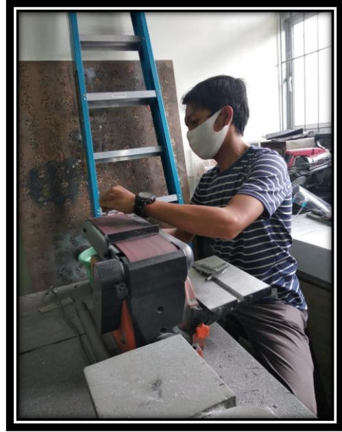
Gambar B.2 : Proses pengamplasan spesimen
