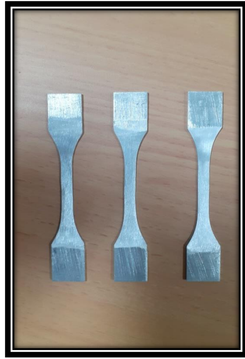
Gambar B.4 : Spesimen uji fatik korosi
