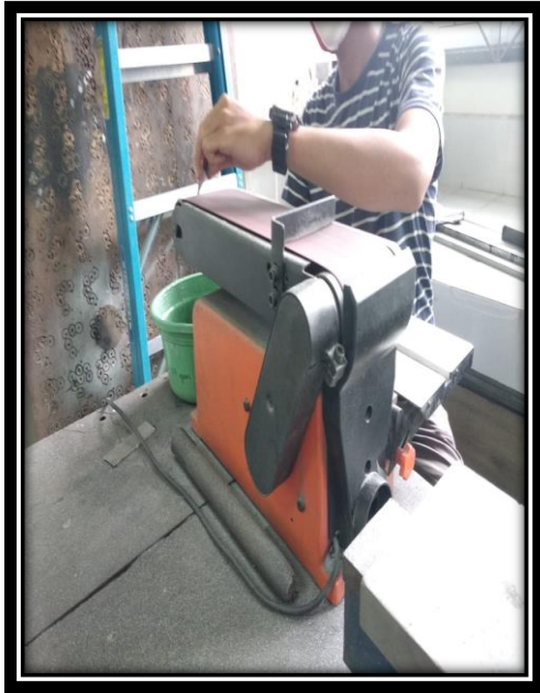
Gambar B.2 : Proses pengamplasan spesimen
