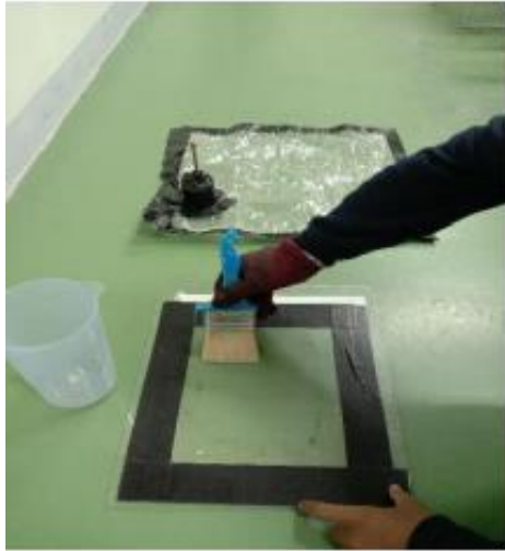
Pengolesan resin dan peletakan serat karbon ke media pencetakan
