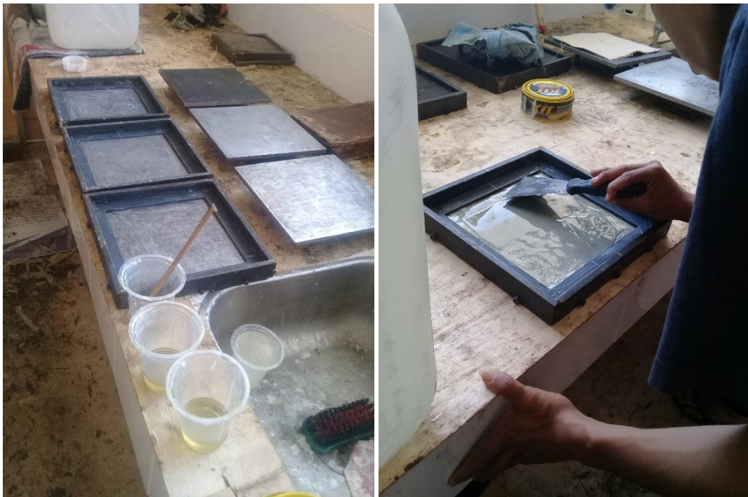
Dokumentasi persiapan alat serta bahan & proses perataan campuran matriks di dalam cetakan
