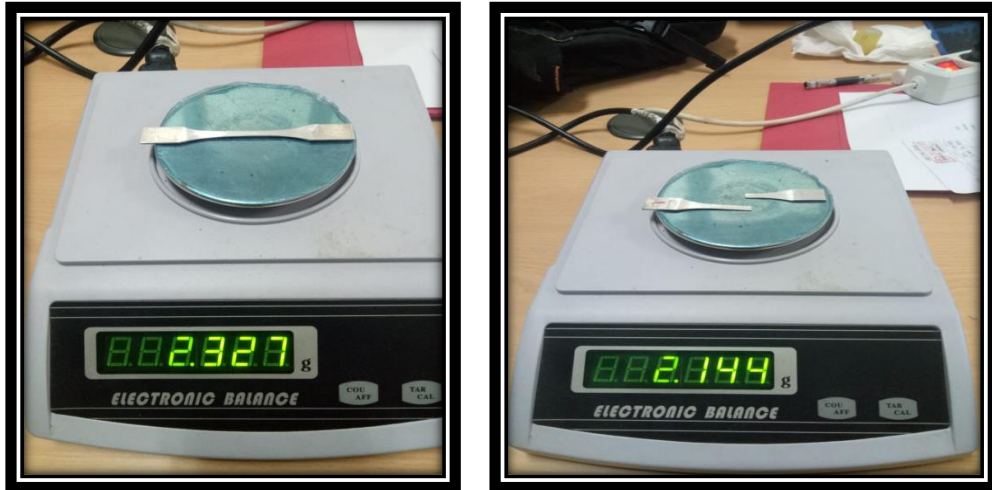
Gambar B8 Proses penimbangan spesimen
