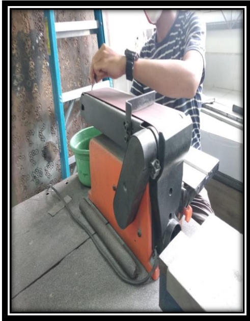
Gambar B.2 : Proses pengamplasan spesimen
