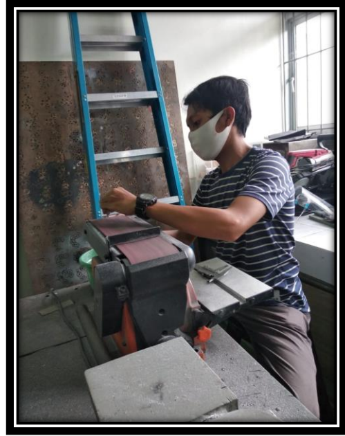
Gambar B.2 : Proses pengamplasan spesimen
