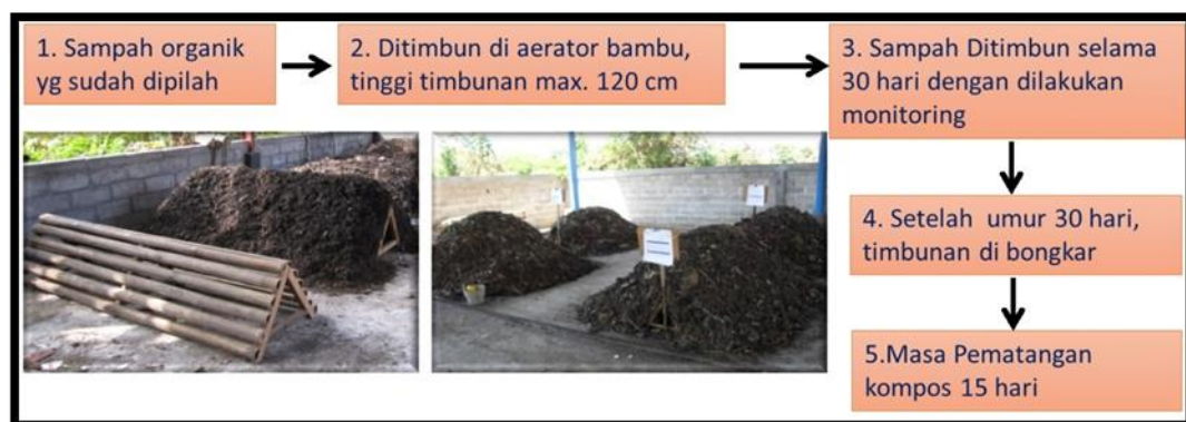
Gambar 0.1. Alur kerja pengolahan aerator bambu (Sumber: Buku Petunjuk Teknis TPS 3R, 2017)
