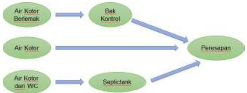
Gambar 1.33 Sistem distribusi pembuangan air kotor
