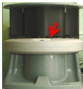
Gambar 2.9 Scanner laser Scan X. Plate storage phosphor dimasukkan ke bagian atas scanner (panah atas) dan dikeluarkan (panah bawah) setelah proses scan selesai.
