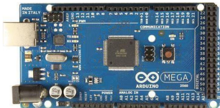
Gambar 2. 2 Bentuk Fisik Arduino Mega 2560 Tabel 2.1 Spesifikasi Arduino Mega 2560
