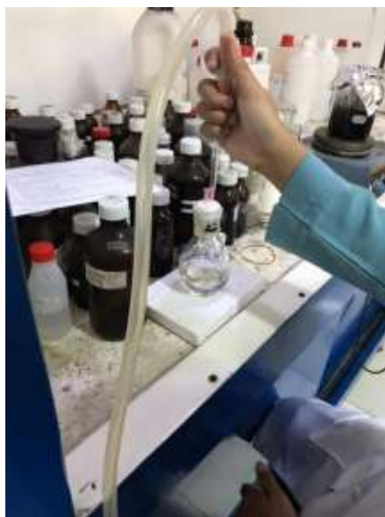
Pengaliran gas nitrogen untuk menghilangkan gas oksigen
