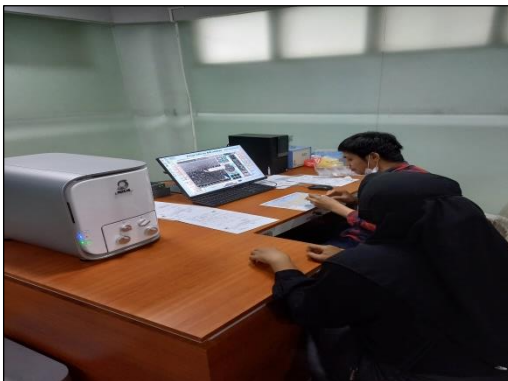
Analisis Morfologi Mikrokapsul dengan Menggunakan SEM
