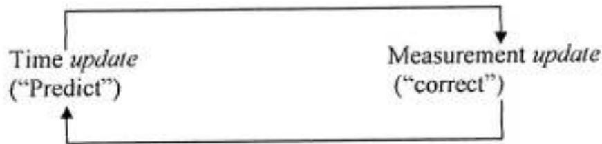
Gambar 2.1 Siklus Kalman Filtering yang sedang berlangsung. Time update memproyeksikan estimasi keadaan sekarang yang berlanjut terus kedepan. Measurement up date mengatur estimasi yang diproyeksikan melalui pengukuran aktual pada saat itu.
