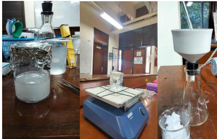
Proses pencucian polimer dengan aseton, metanol, dan akuades agar bersih dari pengotor
