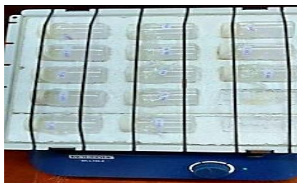
Pengocokan dengan alat shaker untuk pengaruh waktu dan konsentrasi terhadap adsorpsi DEHP
