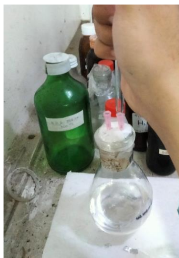
Pengaliran gas nitrogen untuk menghilangkan gas oksigen
