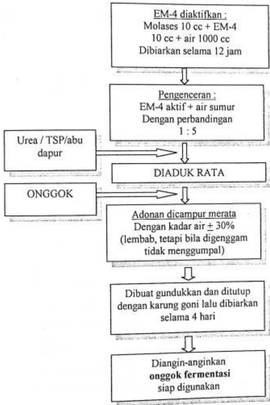
Gambar 2. Skema pembuatan onggok fermentasi
