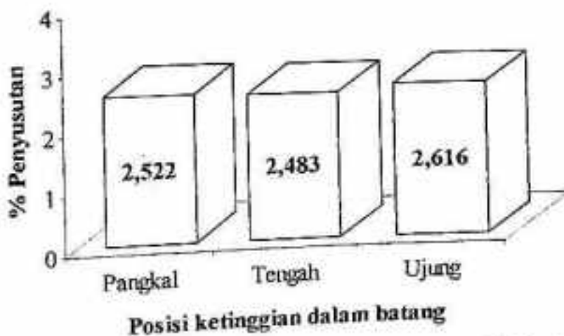
Gambar 12. Diagram Batang Penyusutan Arah Tangensial dari Kondisi Kering Udara ke Kering Tanur Rata-rata pada Posisi Ketinggian dalam Batang.
