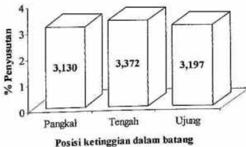
Gambar 16. Diagram Batang Penyusutan Arah Radial dari Kondisi Kering Udara ke Kering Tanur Rata-rata pada Posisi Ketinggian dalam Batang.
