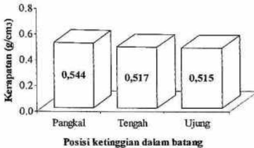
Gambar 9. Diagram Batang Kerapatan Kayu Kering Tanur Rata-rata pada Posisi Ketinggian dalam Batang.
