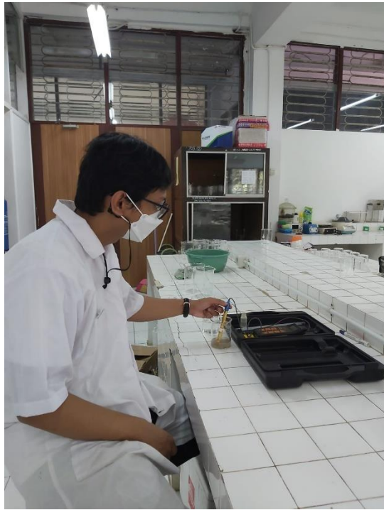
Gambar 22. Pengukuran pH sedimen dengan menggunakan pH meter.
