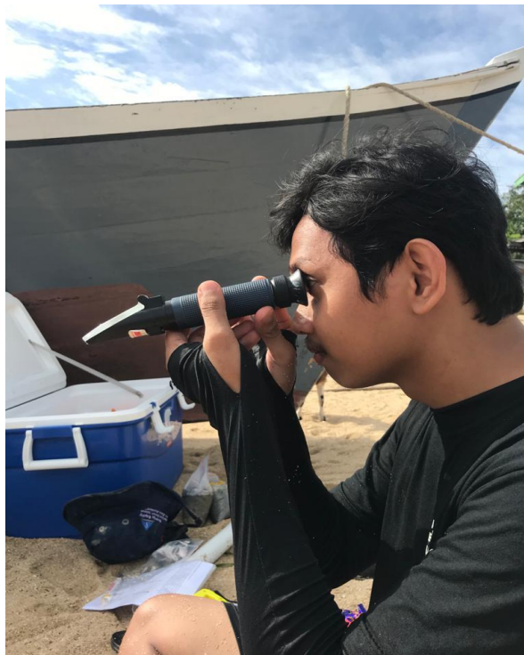
Gambar 19. Pengukuran salinitas air laut menggunakan Hendrefractometer .
