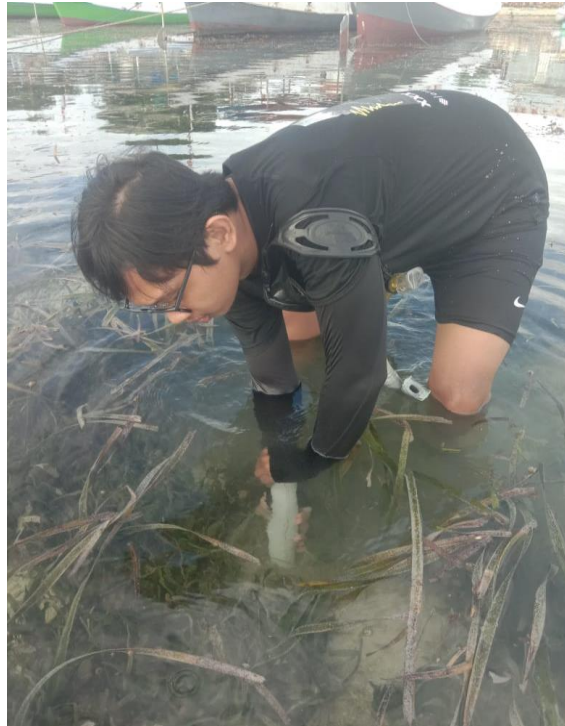
Gambar 18. Pengambilan sampel substrat dengan menggunakan paralon PVC (diameter 5 cm, panjang 20 cm).
