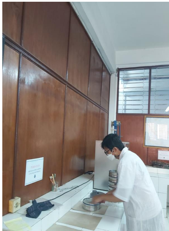
Gambar 23. memisahkan sedimen dari masing masing sieve net.
