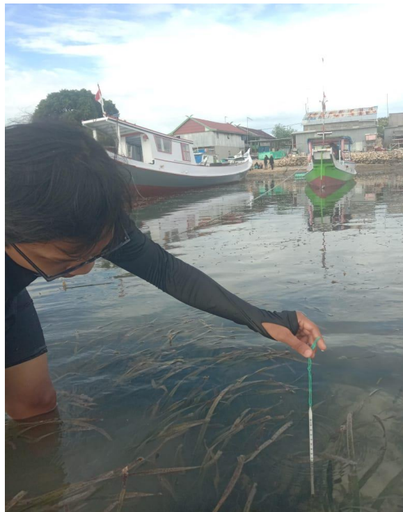
Gambar 21. Pengukuran suhu air laut menggunakan termometer.
