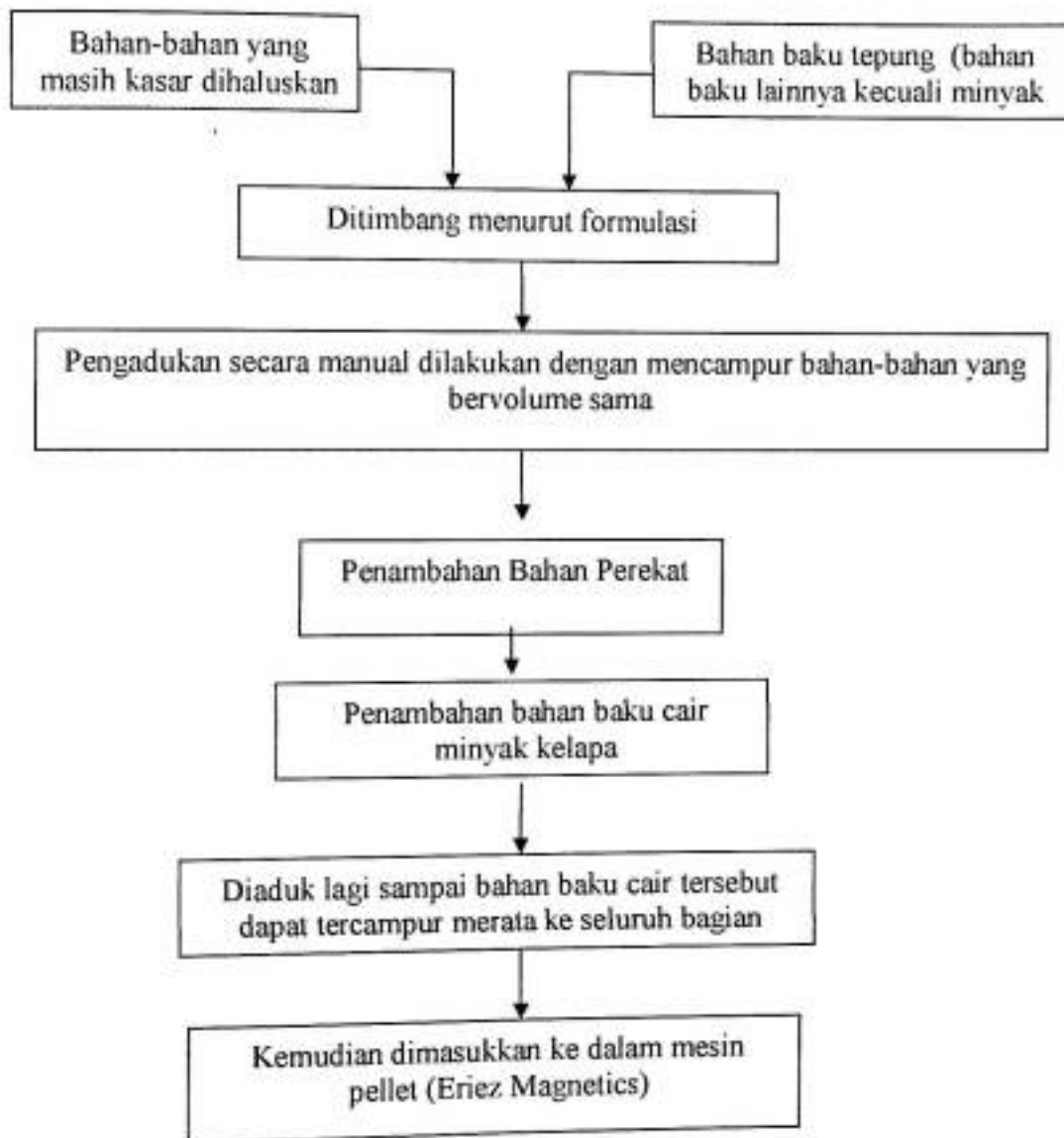
Gambar 3. Diagram Proses Pembuatan Pakan Bentuk Pellet
