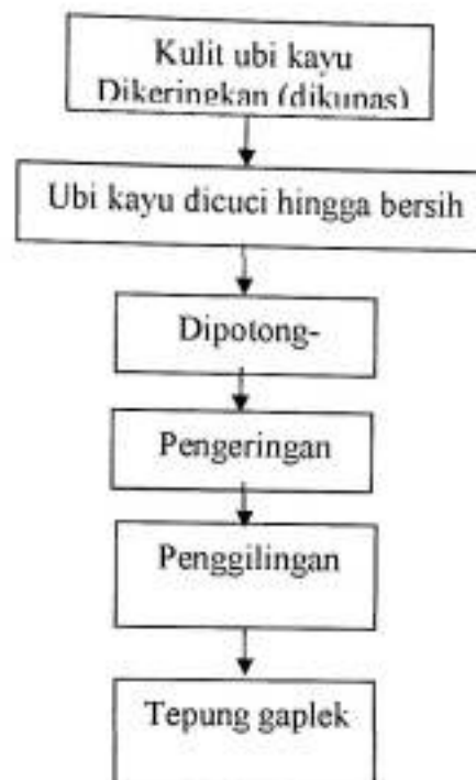
Gambar 2. Proses Pembuatan Gapplek.
