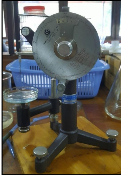
Gambar 30. Tensiometer Du Novy
