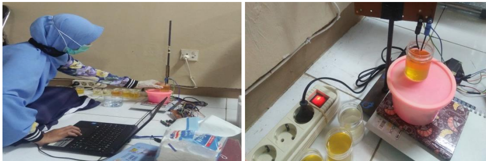
Lampiran 7. Pengukuran kadar gula dalam urine menggunakan sensor serat optik
