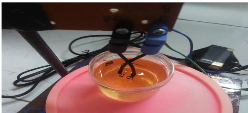
Lampiran 8. Foto sensor serat optik dicelupkan ke dalam urine
