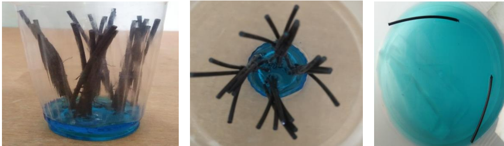
Lampiran 6. Sensor serat optik kadar gula urine konfigurasi gamma , konfigurasi spiral spring dan konfigurasi loop dengan selubung \text{CuSO}_4
