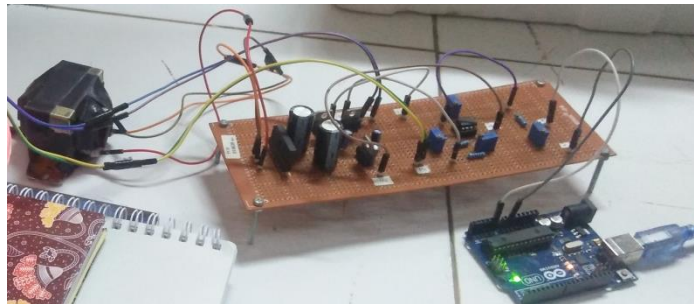
Lampiran 3. Rangkaian catu daya, penguat selisih, trafo dan arduino uno
