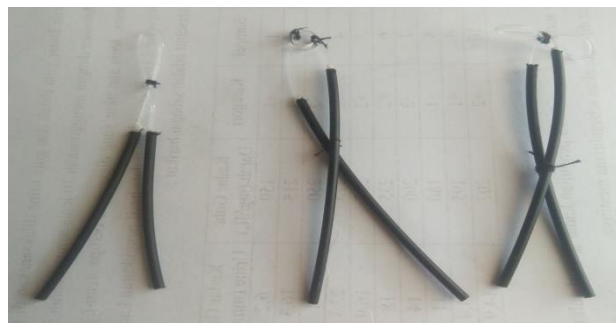
Lampiran 4. Sensor serat optik kadar gula urine konfigurasi gamma , konfigurasi spiral spring dan konfigurasi loop tanpa selubung \text{CuSO}_4
